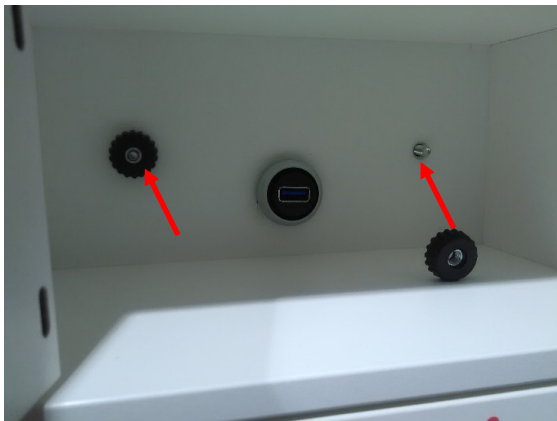
Ladebox in Montagewinkel einhängen und mit Rändelmuttern befestigen
